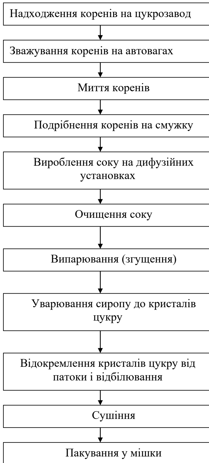
Рис 1 Технологічна схема переробки цукрових буряків фільтрування.
